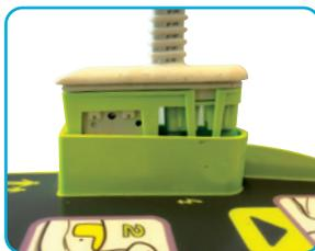
5 Sett i den nye elektroden i kontakten. Trykk hardt ned.
