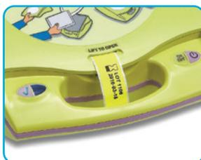
7 Trekk den gule datolappen ut gjennom åpningen på lokket.
